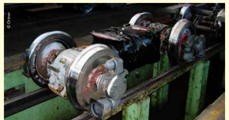
Antriebseinheit: Achsen mit Gleichstrommotor und Getriebe
